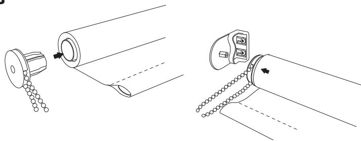
Aseta mekanismi putken päähen sille puolelle, jolle kannake A on asennettu. Laita mekanismilla varustettu putki kannakkeeseen.
