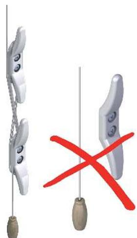
Lapsiturvalaite tulee asentaa vähintään 150 cm korkeudelle lattiatasosta. Lapsiturvalaite tulee asentaa (=kiinnittää karmiin tai seinään) ketjulenkin päähän niin että ketju on kireällä koko ajan. Oikea asennus on näytetty kuvissa 1 ja 2.
